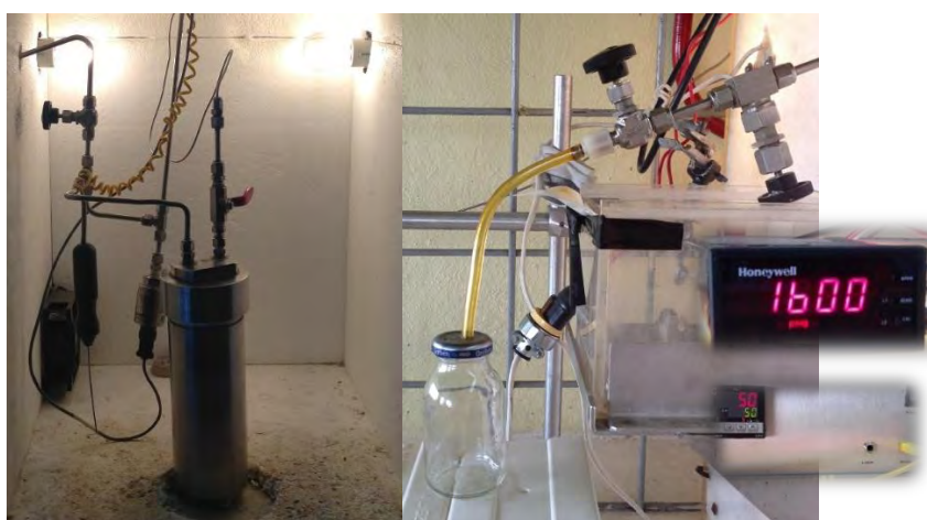
Figura 23. Equipo empleado para la extracción con CO 2 SC. (Equipo ubicado en la facultad de química de la UAEM).
