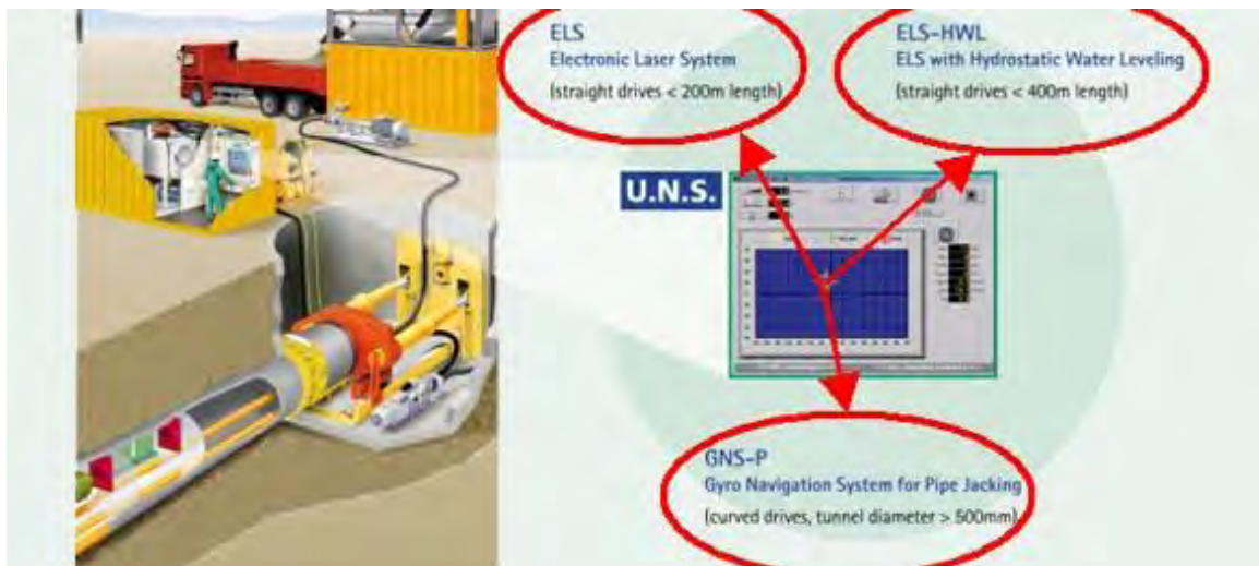
Figura 2.7. Esquema UNS, Herrenknecht. Tomado de http://www.herrenknecht.com .
