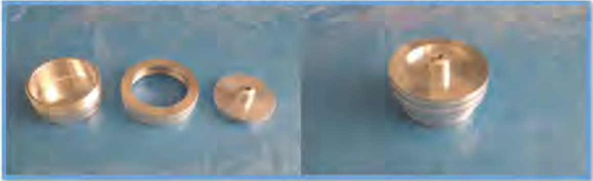
Ilustración 25. Picnómetro metálico desarmado y armado.
