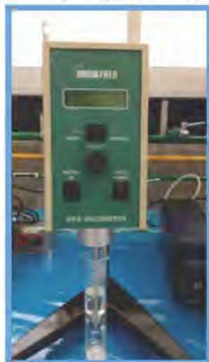
Ilustración 22. Viscosímetro utilizado en la medición de la viscosidad.
