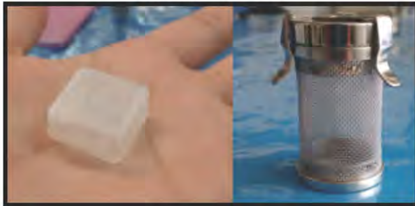
Ilustración 29. Reservorio cargado y aditamento donde el reservorio se coloca en su interior.
