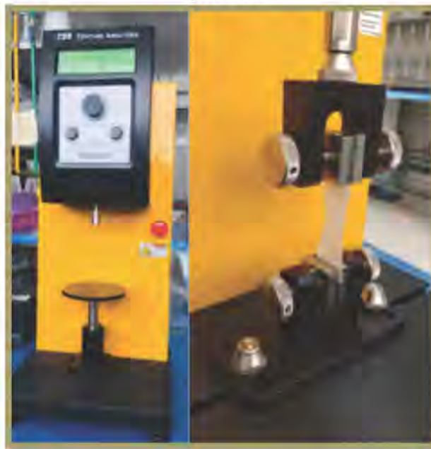
Ilustración 26. Texturómetro y ejemplo de la colocación del parche en las pinzas.
