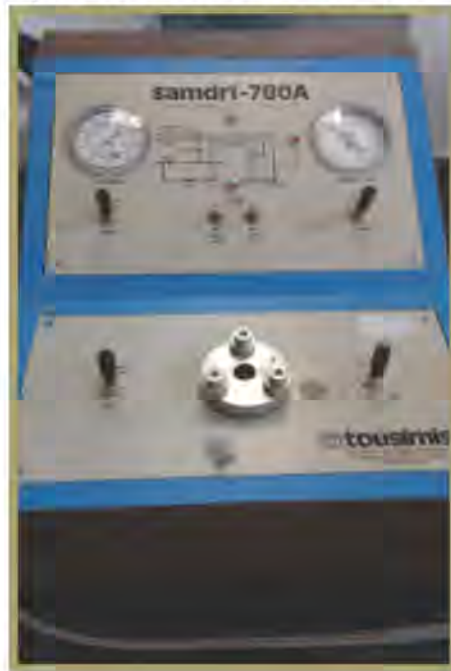
Ilustración 31. Aparato de secado crítico Samdri-780 a .
