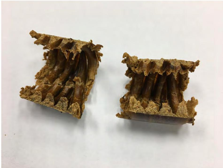
Figura 3.10 Tapón formado dentro del extrusor.
