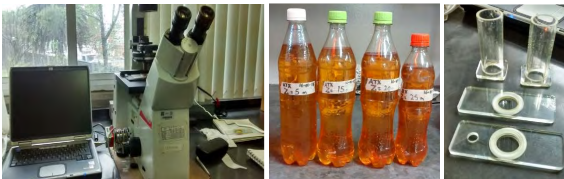
Figura 5. Microscopio invertido con contraste de fases, objetivo de 100x y cámara. Botellas con muestras de fitoplancton fijadas con Lugol y cámaras de sedimentación.
