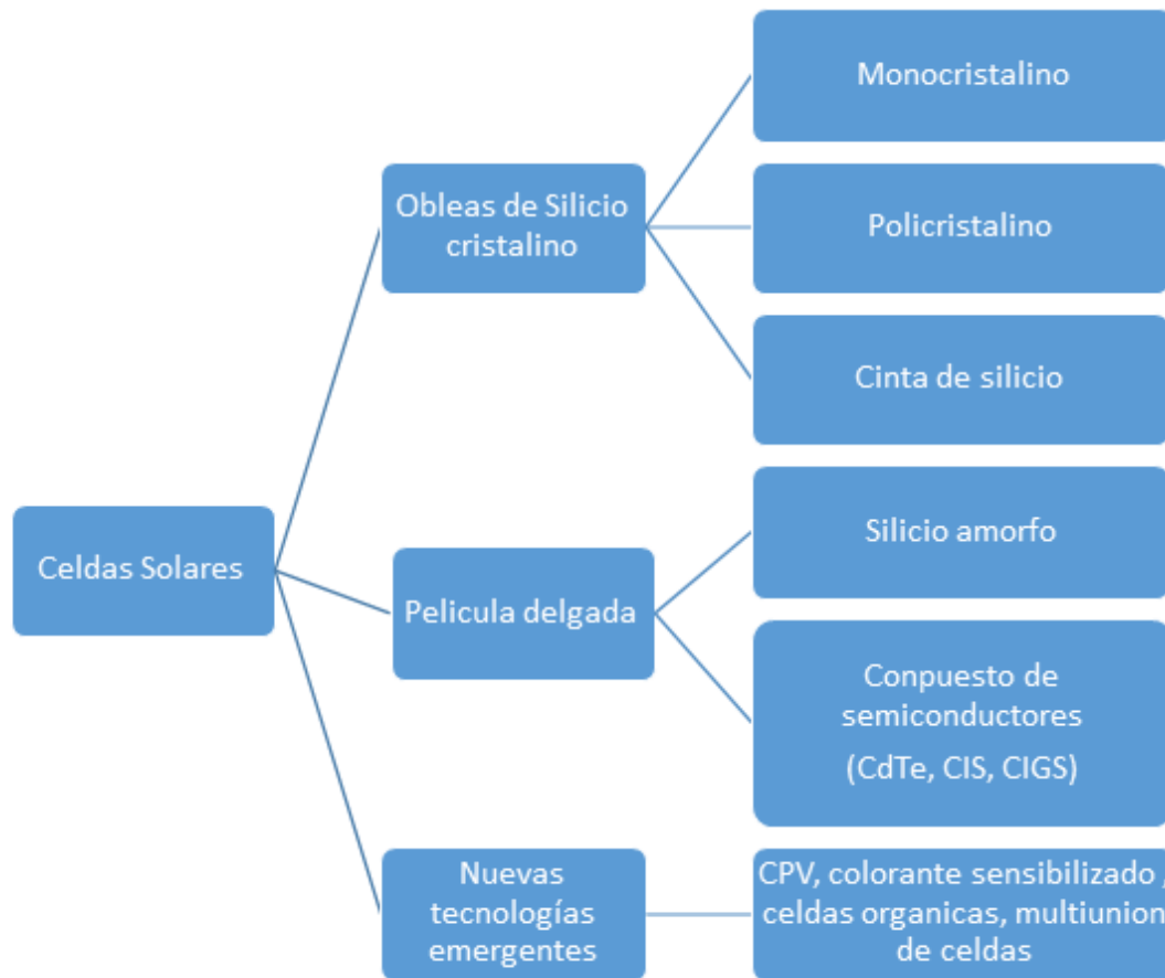
Fig. 2.12. Clasificación de tecnologías de las celdas solares.
