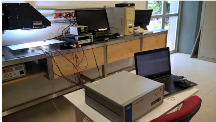
Fig. 4.12. Conexión de los equipos y de la celda para la toma de curva I-V.
