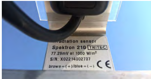
Fig. 3.31. Datos de calibración celda Spektron 210.
