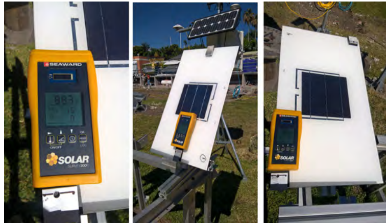
Fig. 3.22. Procedimiento usado para dejar inclinadas las celdas.
