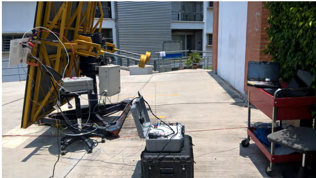
Fig. 4.61. Conexión del trazador de curvas ECKO para poder medir las curvas a diferentes inclinaciones.
