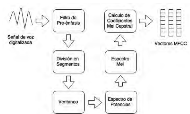
Figura 2.6: Módulo de extracción de atributos de un sistema ASR.
