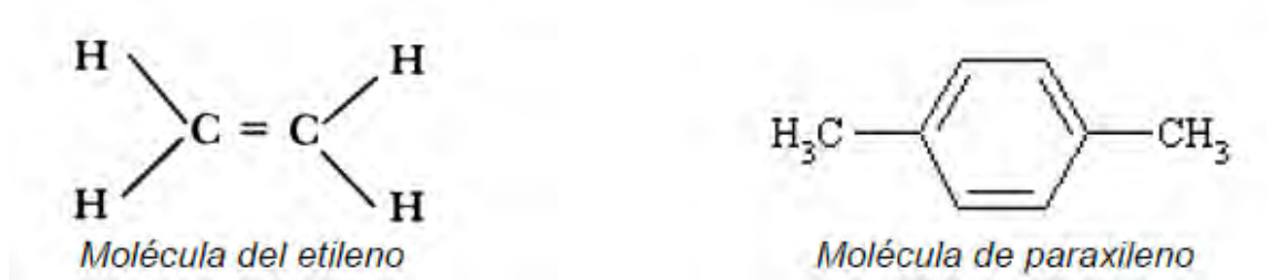
Ilustración 8. Formulas estructurales de las moléculas de Etileno y Paraxileno 25
