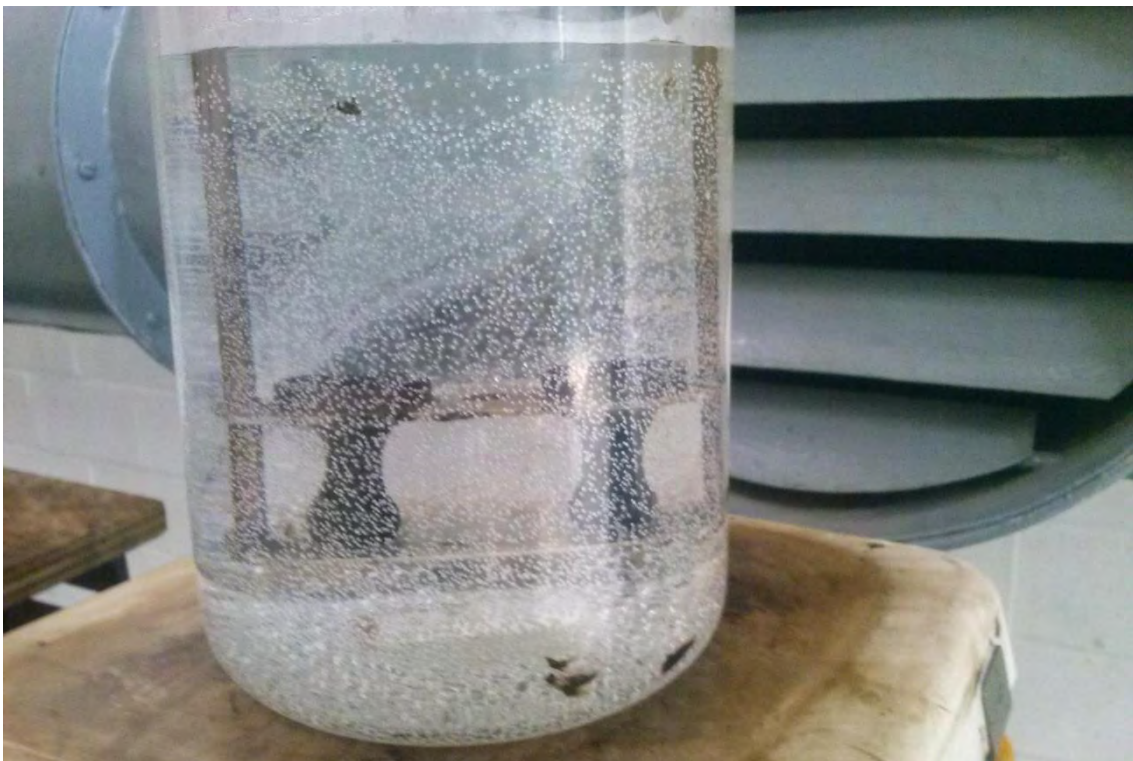
Ilustración 22. Asfaltos modificados sometidos a la prueba de ablandamiento.
