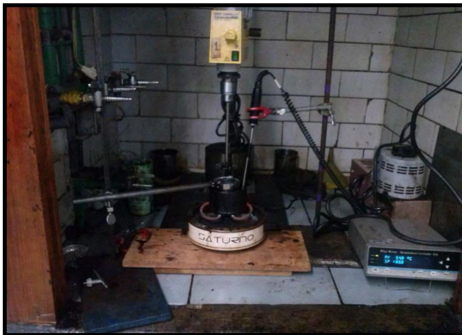
Ilustración 17. Arreglo para la modificación polimérica con PET.
