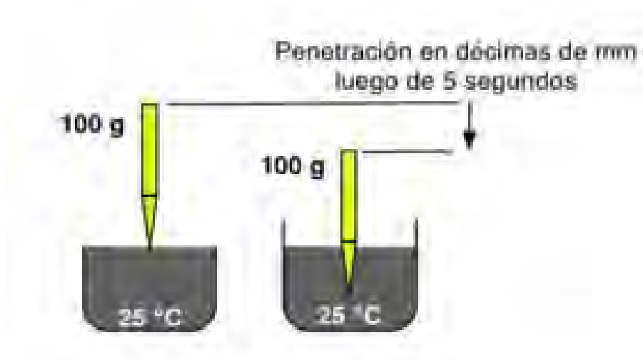
Ilustración 13. Esquema de la aguja penetrando el asfalto 46 .
