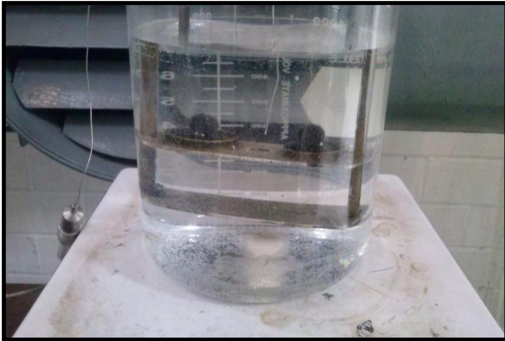
Ilustración 22. Asfaltos modificados sometidos a la prueba de ablandamiento.
