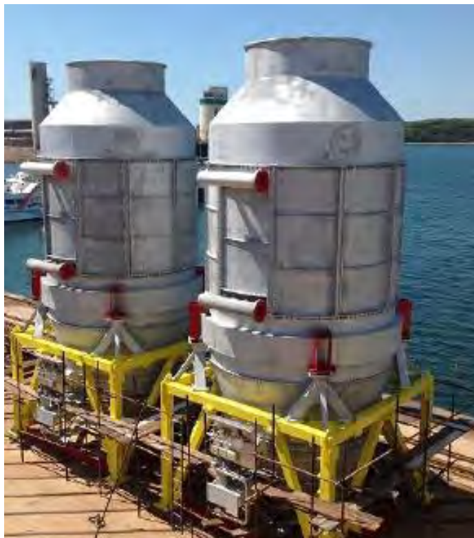
Figura 4.20 Unidades de recuperación de calor (Cameron, 2015).
