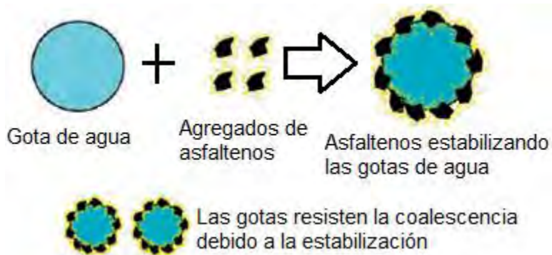
Figura 1.12 Mecanismo de estabilización de emulsiones (Kokal, 2006).
