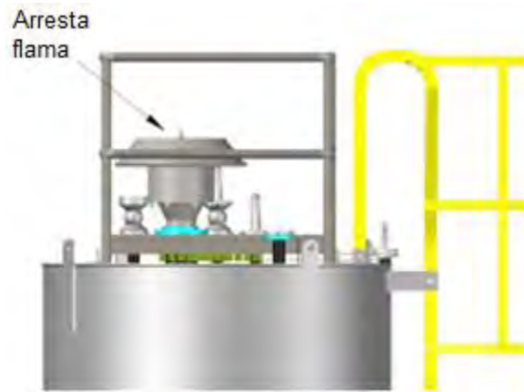
Figura 4.8 Arresta flama en tanques de almacenamiento de químicos (Cameron, 2015).
