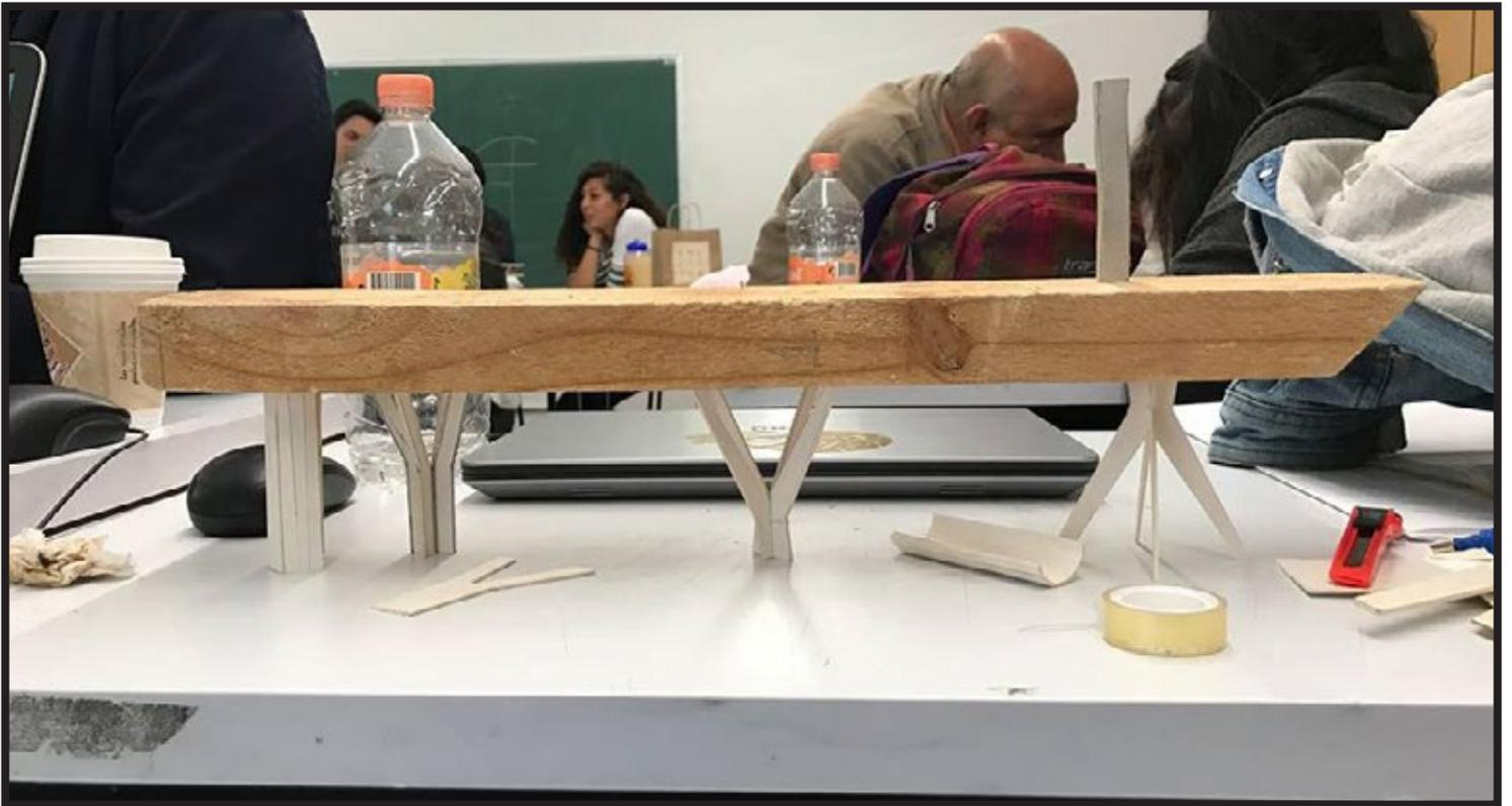
1. Se experimentó con modelos de papel batería para explorar la estabilidad de varias propuestas de columnas para el proyecto.
