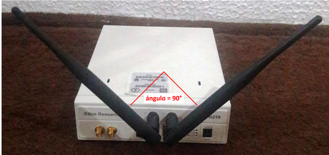
Figura 3.5 Vista del dispositivo N210 con antenas instaladas.
