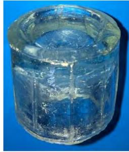
Fig. 18. Godete: este utensilio facilita la mezcla y sostén de la pasta que se prepara con el polvo de piedra pómez (Sánchez, 2018).
