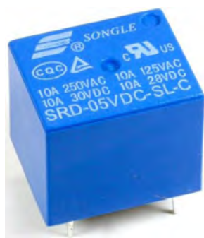
Figura 4.8 Relevador SONGLE de 5 V.
