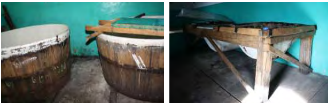
Figura 40 Fotografía de las tinas de encino y de cuero de res para el proceso del pulque, 2016.
