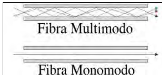
Figura 2.8 Distorsión de la luz en fibra monomodo y multimodo
