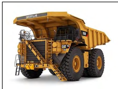
Figura 2.5 Camión de carga pesada modelo CAT 789 D, empleado en el sector minero. Imagen tomada de productos Caterpillar.
