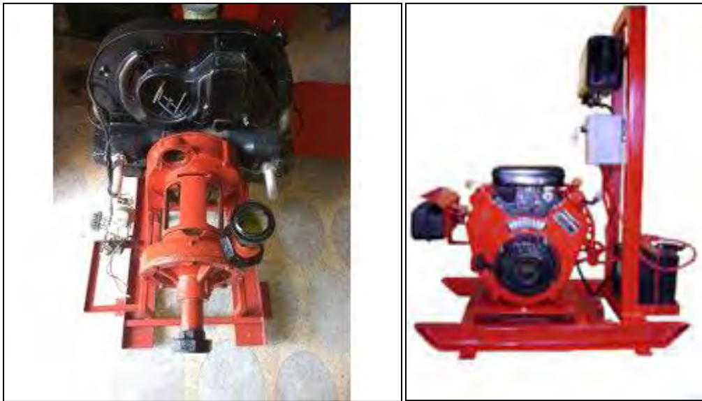
Figura 2.7 La versatilidad en la velocidad angular que ofrece un motor a gasolina es hoy en día una opción poco segura pero aún empleada como alternativa para acoplarse con una bomba contra incendio. Derrames de un combustible altamente inflamable, así como el uso de chispa, han sido factores determinantes para éstos sean sustituidos por equipos más seguros como lo son los motores Diesel.
