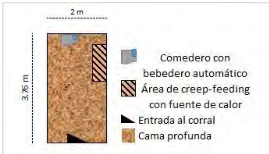
Figura 2.23. Corral para parto con cama profunda en sistema Ljunström. Medidas: 3.76 m por 2 m. Morales-Ramírez, 2018.
