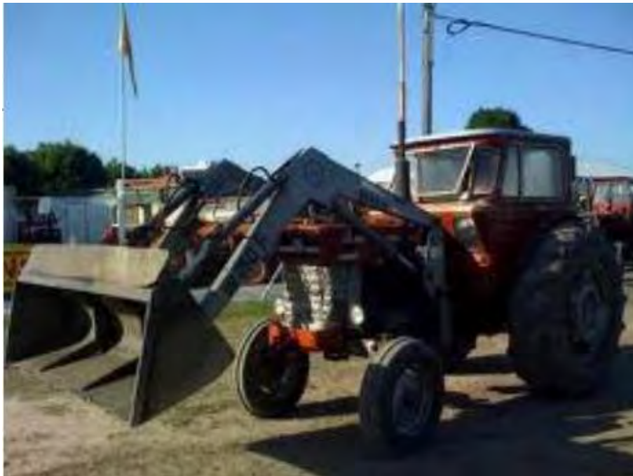
Figura 1.28. Tractor con pala frontal, para la remoción de la cama. Tomada de: Subsecretaría de asuntos agrarios, 2015.
