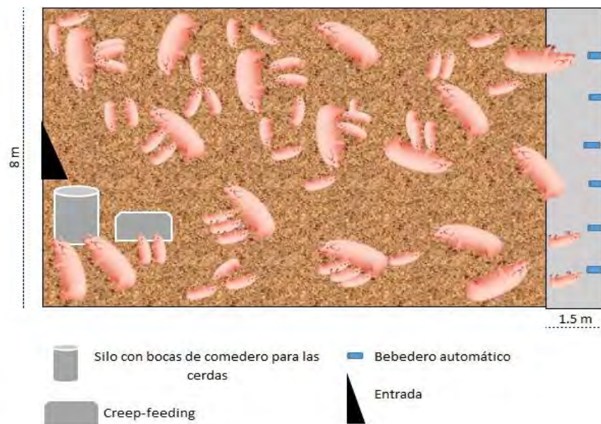
Figura 2.25. Corral de lactación grupal en sistema Ljunström. Medidas: 15m por 8 m, con área de bebederos de 1.5 m de ancho. Morales-Ramírez, 2018.
