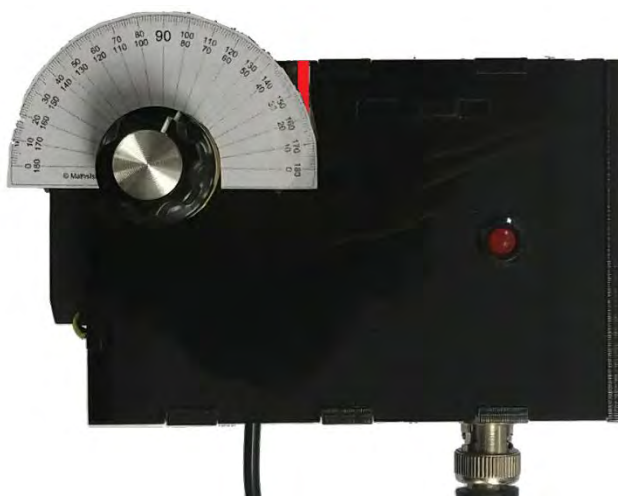
Figura 26. Equipo de detección de fase con medidor de ángulo.
