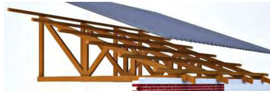
Figura 34. Armado de madera para constituir la cubierta.
