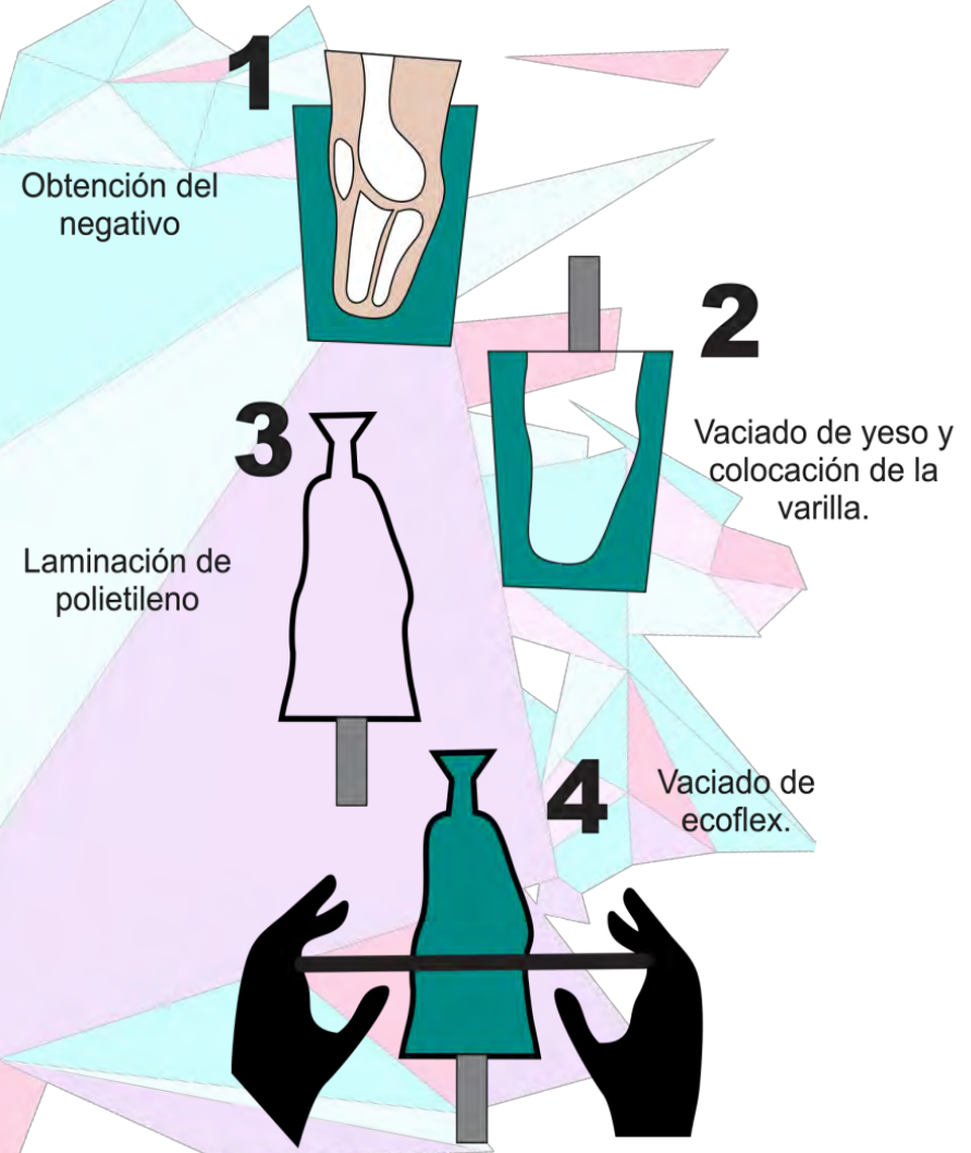
Figura 68: Esquema del proceso del encaje Elaboración propia
