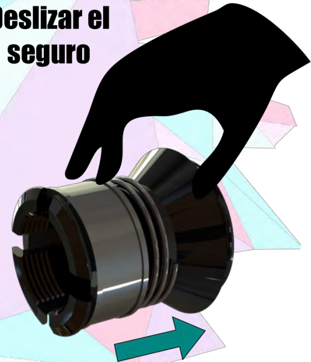
Figura 87: Retiro del seguro de la lanzadera Elaboración propia
