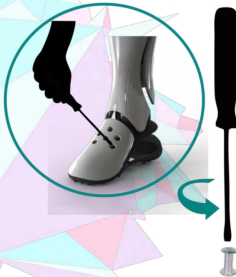
Figura 116: Destornillamiento cabezales. Elaboración propia
