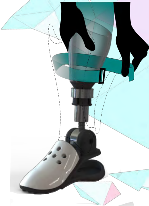
Figura 90: Colocación de la correa de neopreno. Elaboración propia
