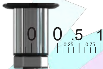
Figura 114: Mecanismo de ajuste milimétrico Elaboración propia
