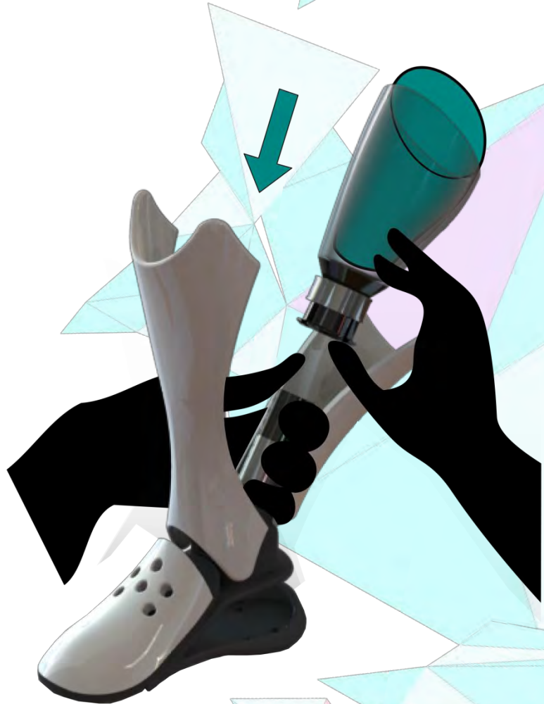
Figura 88: Secuencia del acople encaje-soporte Elaboración propia
