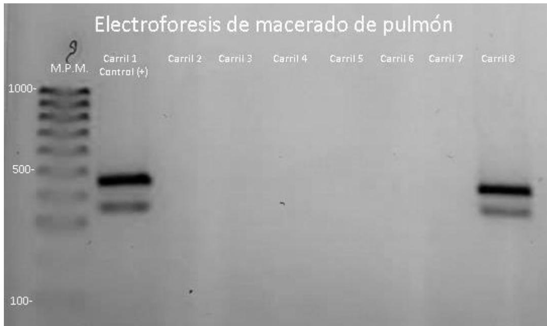
**Figura 20. Electroforesis de macerado de pulmón: Se observa (de izquierda a derecha) el marcador de peso molecular, el control positivo (serotipo cinco) para el primer carril, en el segundo, en el tercer, en el cuarto, en el quinto, en el sexto y en el séptimo carril se observa un resultado negativo (debido a que no hay banda) y en el octavo carril la muestra positiva de macerado de pulmón.**
