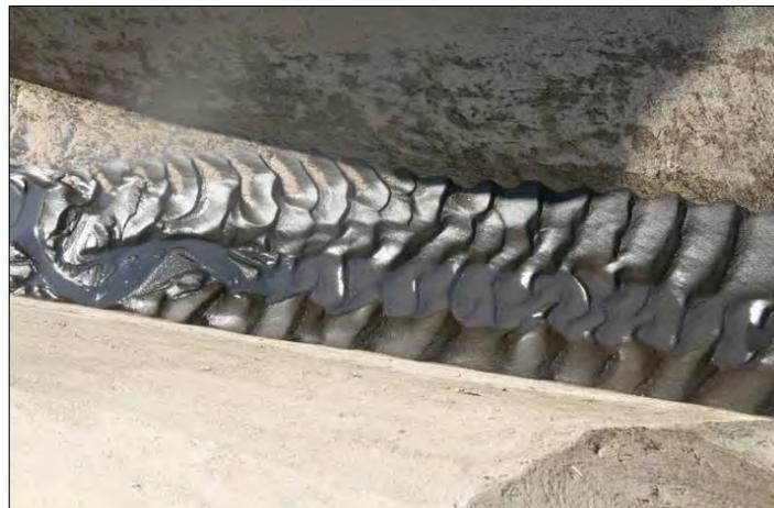
**Figura 4.12.** Formación de dunas en el arrastre de fondo sección 139+000, arena negra.
