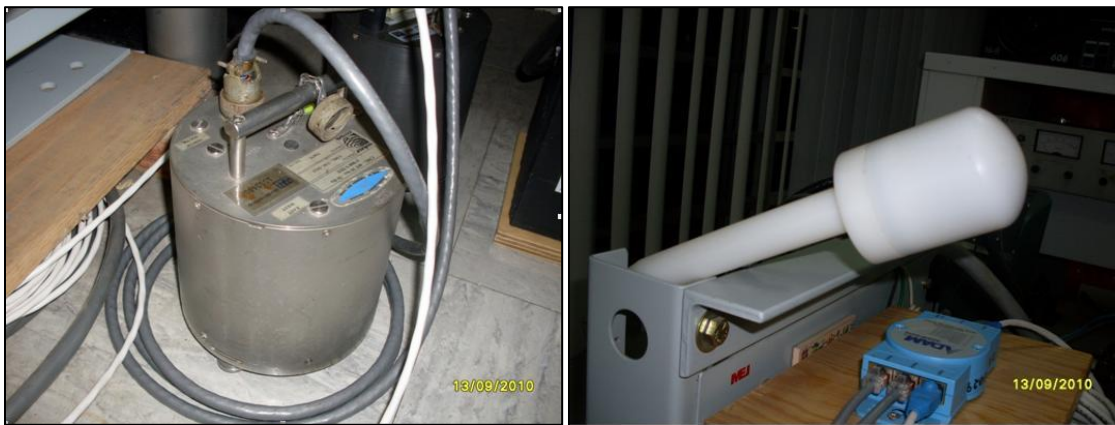
Figura 5 Izquierda: Sismómetro de banda ancha marca Guralp modelo 6TD. Derecha: Reloj GPS de alta precisión marca Guralp modelo CMG-GPS2.
