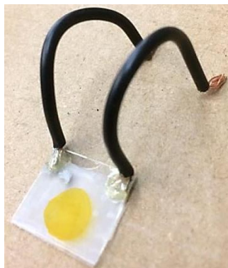
Figura 15. Deposición en celda ITO/PET.
