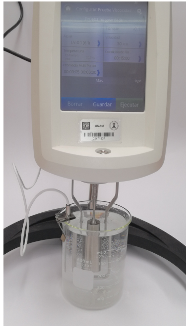
Figura 3.8: Fotografía de prueba con aguja# 61 para glicerina pura en viscosímetro Brookfield DV2T
