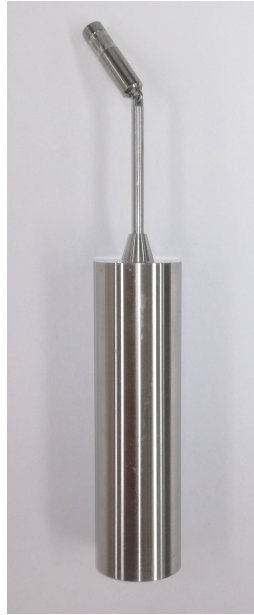
Figura 3.6: Fotografía de aguja del adaptador UL Brookfield
