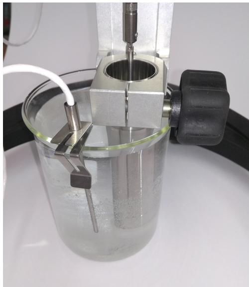
Figura 3.7: Fotografía de ensamble del adaptador UL Brookfield para realizar prueba de viscosidad, el adaptador se encuentra sumergido en agua que proporciona el baño térmico requerido
