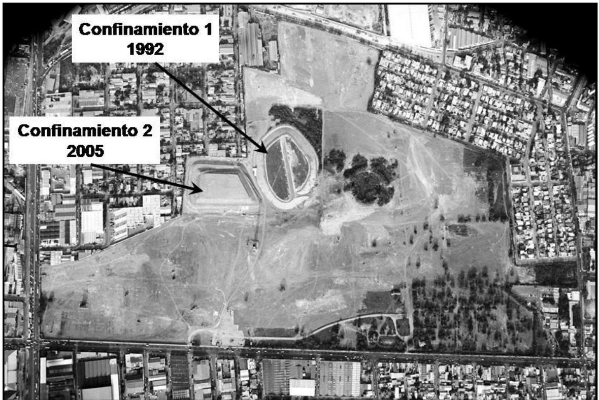
**Figura. 5.4 Vista aérea del predio después de la remediación de los suelos en donde se pueden observar los dos confinamientos construidos para almacenar los residuos de naturaleza inorgánica**
