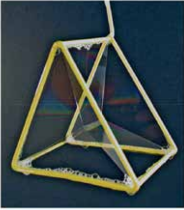
[57].Imágenes de las estructura burbuja, un experimento realizado por David A. Katz. Se observa cómo la sustancia toma la forma de la estructura creando superficies.
