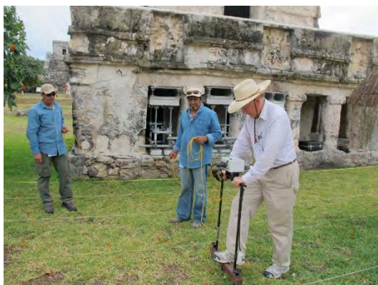
Figura 61. Proceso de prospección por resistividad eléctrica frente al Edificio 16 o Templo de las Pinturas, Tulum. Foto PMQR 2015.
