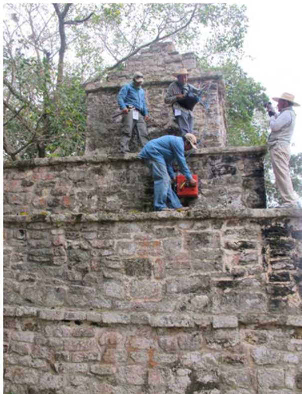
Figura 109. Trabajos de prospección con la antena de georradar de 400 MHz sobre el paramento del tercer cuerpo del basamento en la fachada norte, Estructura 12, Tancah. R. Magdaleno, 2015.
