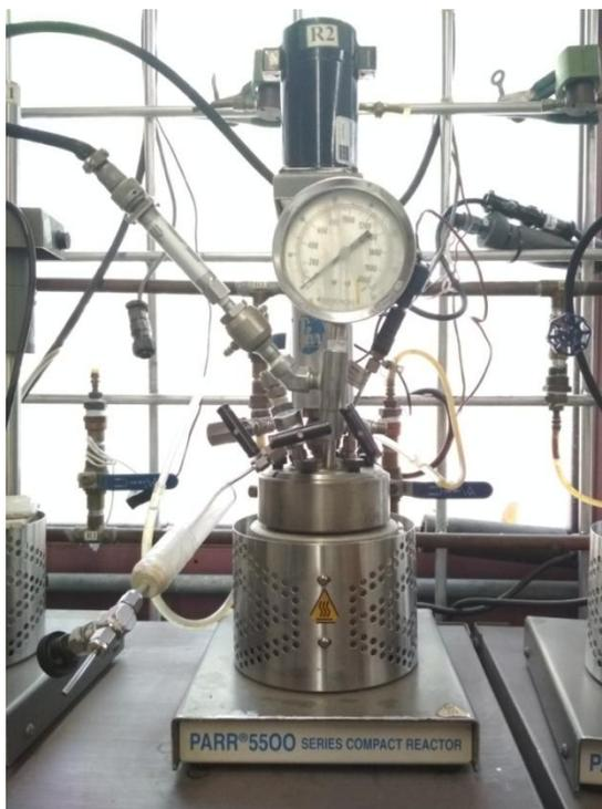
Figura 5-2. Sistema de reacción por lotes Parr con control de temperatura y medidor de presión manométrica.
