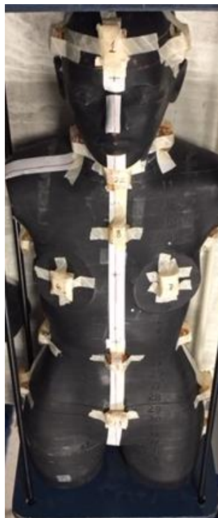
Figura 5. Se muestra la distribución de los OSLd en el fantoma RANDO® mujer.
