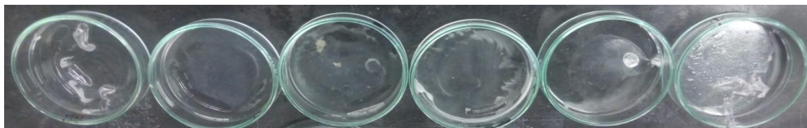
Figura 3.1 Reacción de reticulación, usando ácido malónico (Mal), se observó lo que parece ser la deshidratación de la mezcla reaccionante y sin cambio aparente de coloración respecto a los consiguientes productos (potencia 100 Watts).
