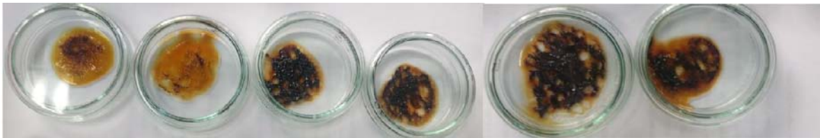
Figura 3.3 Reacción de la membrana reticulada con ácido sulfosuccínico (SSA), la imagen muestra como la película obtenida se oscurece cada vez más a medida que la mezcla es sometida a mayor tiempo dentro del aparato de calentamiento.
