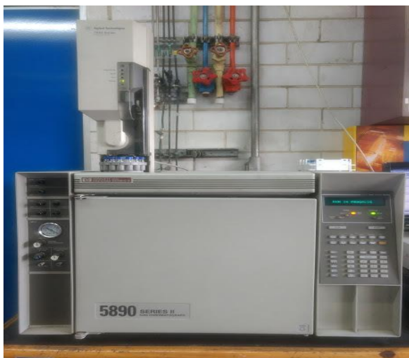
Figura 3.6. Cromatógrafo de gases utilizado para el seguimiento del avance de las reacciones.
