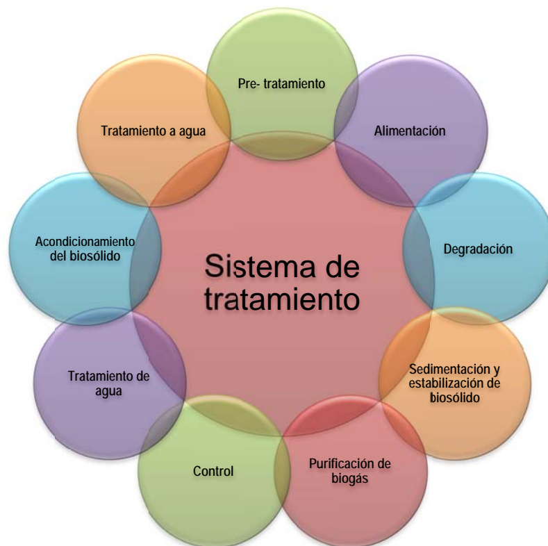
Figura 41.-Esquema simplificado de proceso anaerobio para FORSU
