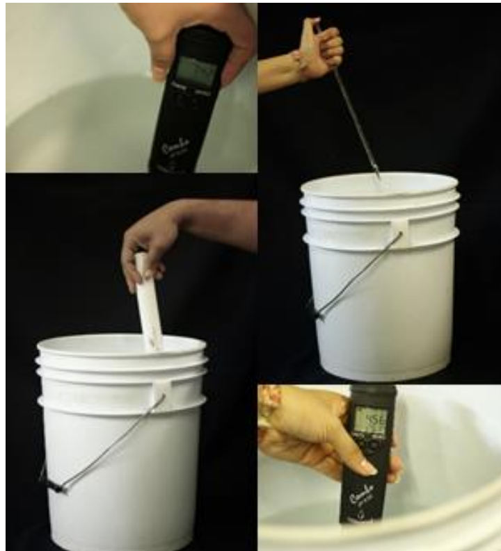
Figura 28. Medición del pH inicial y final después de agregar ácido nítrico y fosfórico.
