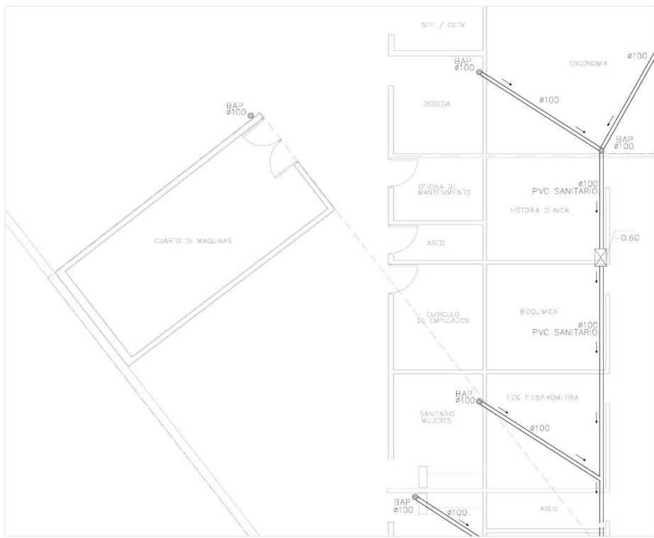
DETALLE INST. PLUVIAL PLANTA BAJA
