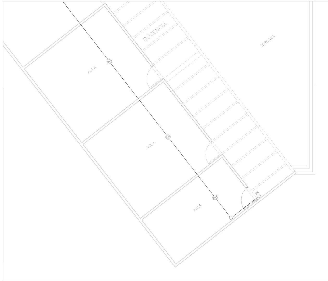
DETALLE INSTALACION DE CCTV AREA DE DOCENCIA
