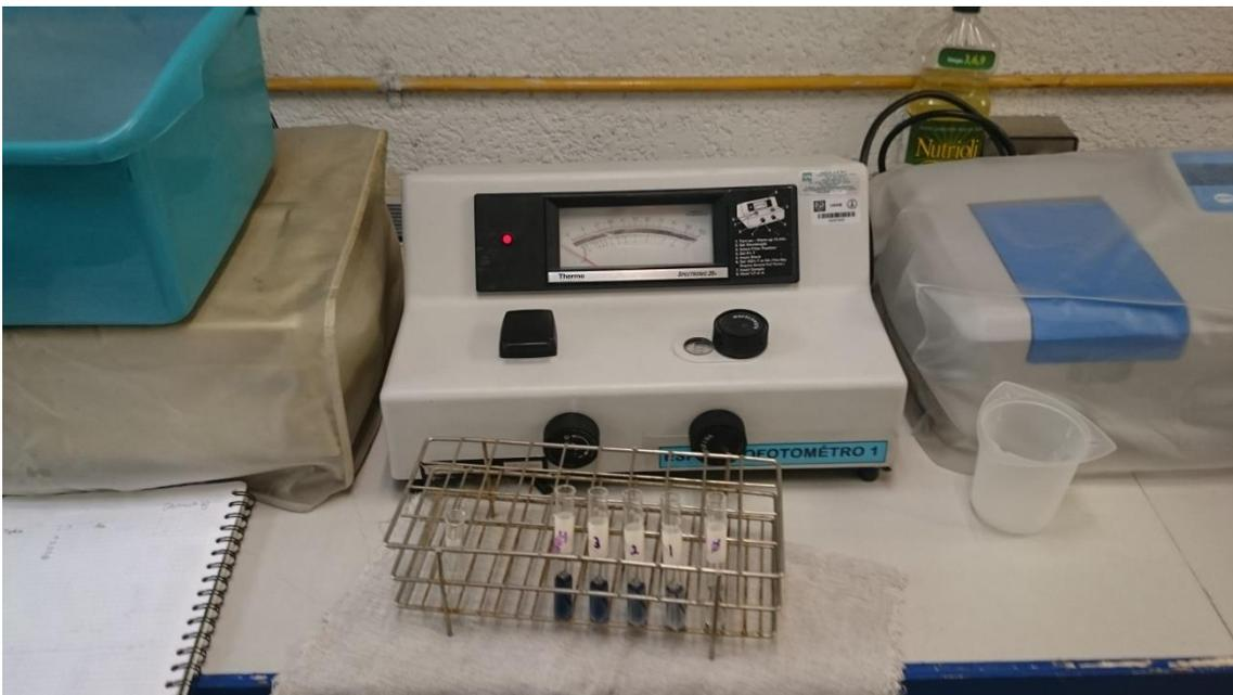
Figura 10.17 – Espectrofotómetro utilizado para las mediciones colorimétricas.
