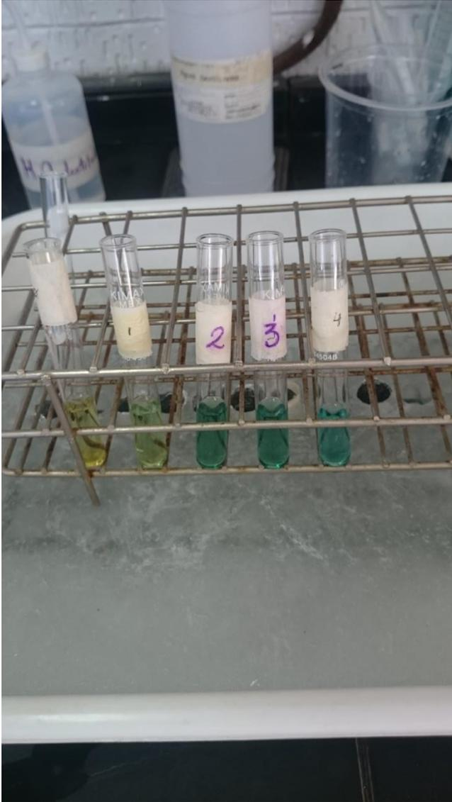
Figura 10.15 – Curva patrón de tubos utilizados para la cuantificación de hexosas por reactivo de antrona.
