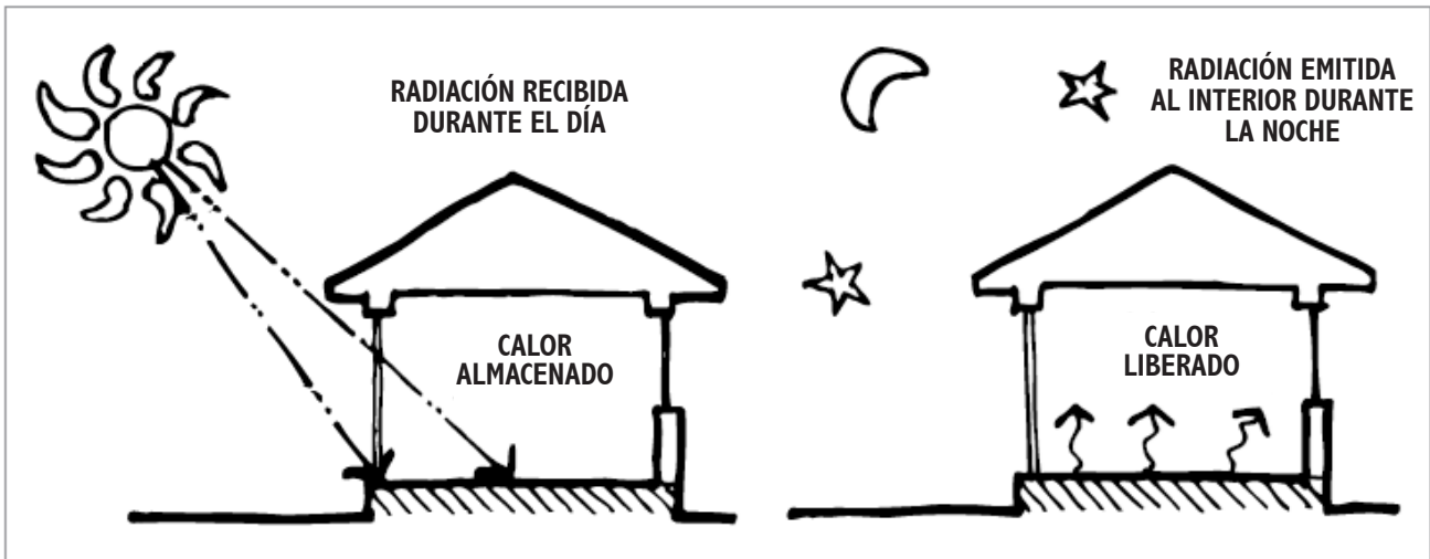
Fig. 18.2 Almacenamiento de calor en masa térmica
