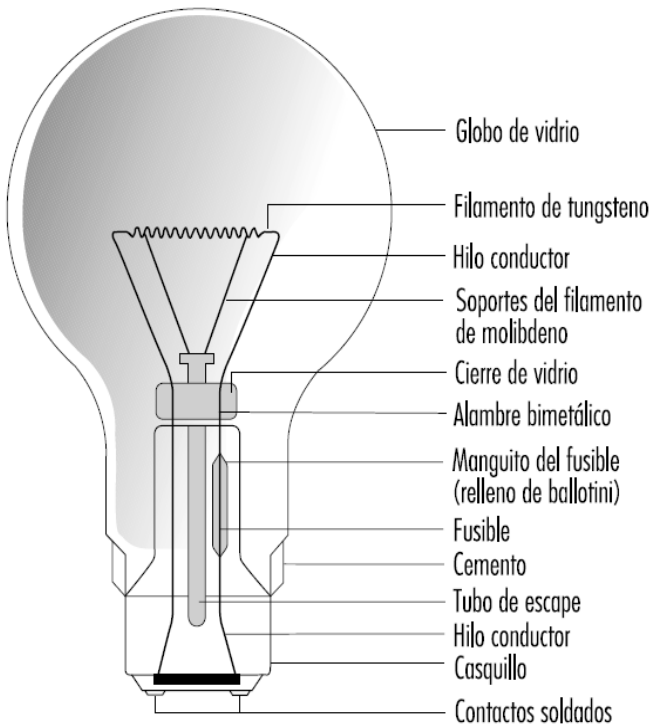
Fig. 40.1 Esquema lámpara incandescente
