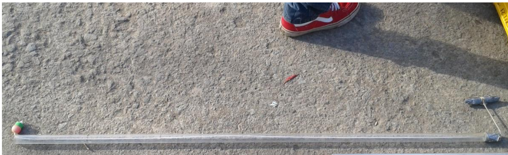
Figura 6. Tubo muestreador utilizado para obtención de muestras integradas de agua del lago.
