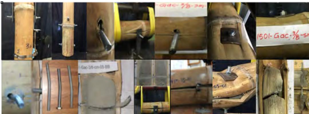
Imagen 86. Ensayos tipo “P” “Q” Y “T” sin y con mortero con perno de 3/8 plg, fallas presentadas, *G. aculeata* de la región de Hueytamalco, Puebla. Fuente: autor.
