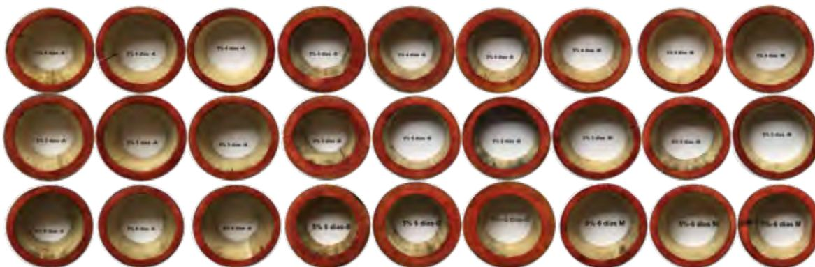
Imagen 44. Resultados de la evaluación penetración y presencia de SB, al 5 %, en 4,5 y 6 días en las partes baja, media y alta del tallo, preservadas con SB por inmersión-difusión. *G. aculeata* de la región de Hueytamalco, Puebla. Fuente: autor.
