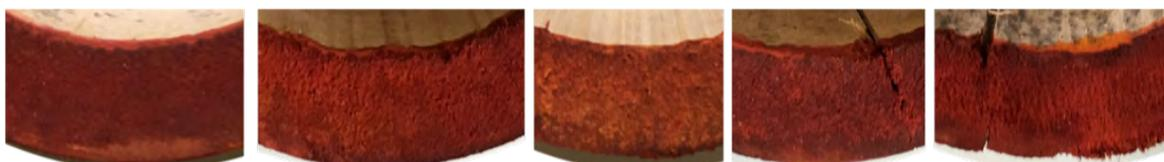
Imagen 138. Resultados, detalles niveles de penetración-presencia de SB, concentración al 6 % durante 7 días, en muestras de tallos del prototipo de vivienda rural. *G. aculeata* de la región de Hueytamalco, Puebla, con la metodología de (Erdoiza & Echenique 1980). Fuente: autor.
