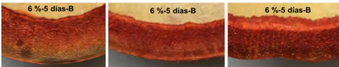
Imagen 50. Resultados, detalle de penetración-presencia de SB, concentración al 6 % en 5 días, partes baja, media y alta del tallo, preservadas por inmersión-difusión. *G. aculeata* de la región de Hueytamalco, Puebla. Fuente: autor.
