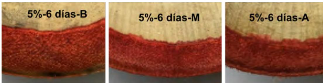
Imagen 47. Resultados, detalle de penetración-presencia de SB, concentración al 5 % en 6 días, partes baja, media y alta del tallo, preservadas por inmersión-difusión. *G. aculeata* de la región de Hueytamalco, Puebla. Fuente: autor.
