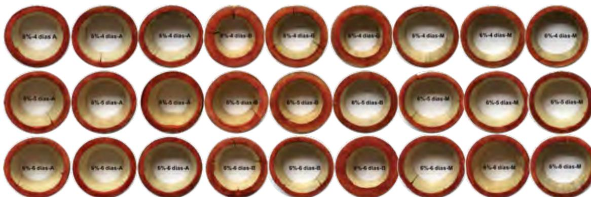
Imagen 48. Resultados de la evaluación penetración y presencia de SB, al 6 %, en 4,5 y 6 días en las partes baja, media y alta del tallo, preservadas con SB por inmersión-difusión. *G. aculeata* de la región de Hueytamalco, Puebla. Fuente: autor.
