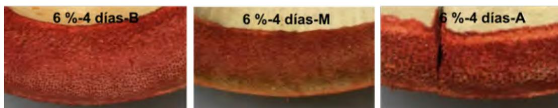
Imagen 49. Resultados, detalle de penetración-presencia de SB, concentración al 6 % en 4 días, partes baja, media y alta del tallo, preservadas por inmersión-difusión. *G. aculeata* de la región de Hueytamalco, Puebla. Fuente: autor.
