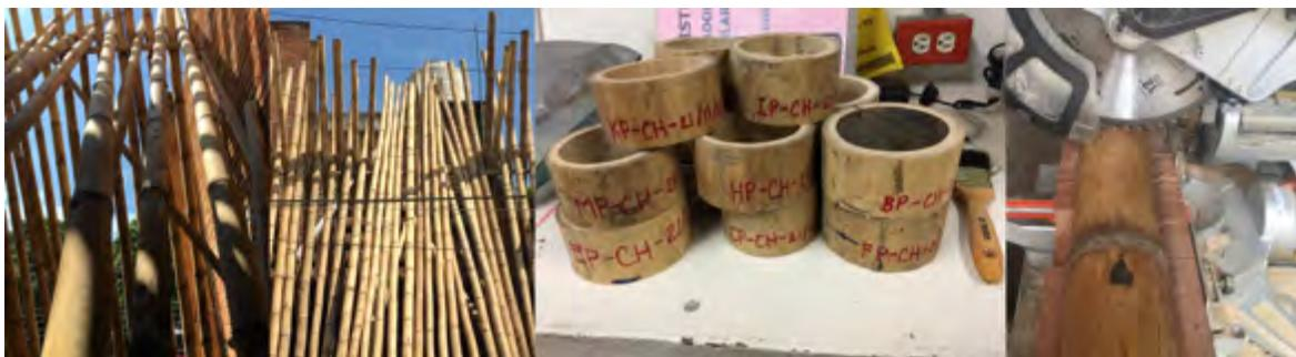
Imagen 54. Secado a la intemperie en la ciudad de Papantla, Ver., tallos de *G. aculeata* de la región de Hueytamalco, Puebla. Corte de rodajas, medición del CH por el método gravimétrico.
