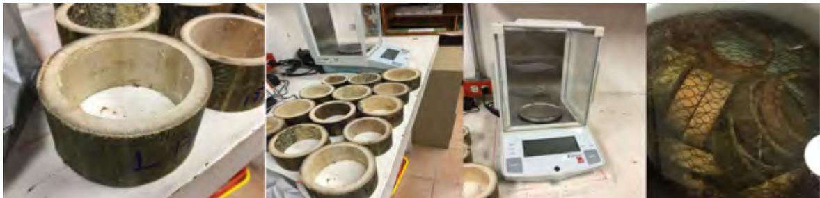
Imagen 53. Medición del CH por el método gravimétrico y cálculo de la densidad básica DB pp/vv. Fuente: autor.
