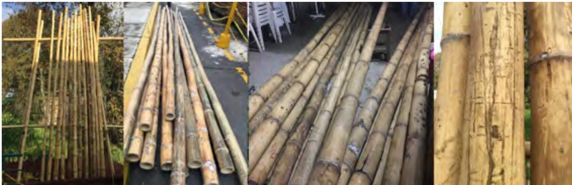
Imagen 52. Secado a intemperie, en la ciudad de Xalapa, Ver., exposición de tallos de *G. aculeata* de la región de Hueytamalco, Puebla. detalle de grietas. Fuente: autor.
