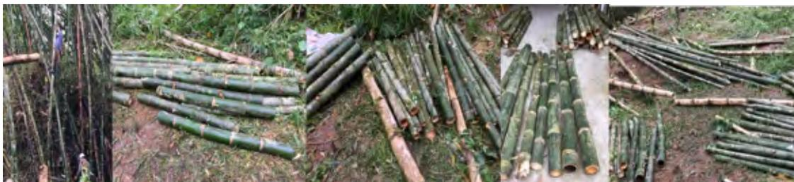
Imagen 38. Extracción preparación de tallos para muestras de 1.5 m de longitud. Fuente: autor.
