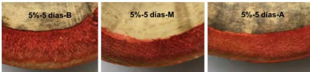
Imagen 46. Resultados, detalle de penetración-presencia de SB, concentración al 5 % en 5 días, partes baja, media y alta del tallo, preservadas por inmersión-difusión. *G. aculeata* de la región de Hueytamalco, Puebla. Fuente: autor.
