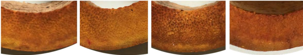
Imagen 136. Resultados, detalles de penetración-presencia de SB, concentración al 6 % durante 7 días. *G. aculeata* de la región de Hueytamalco, Puebla. Fuente: autor
