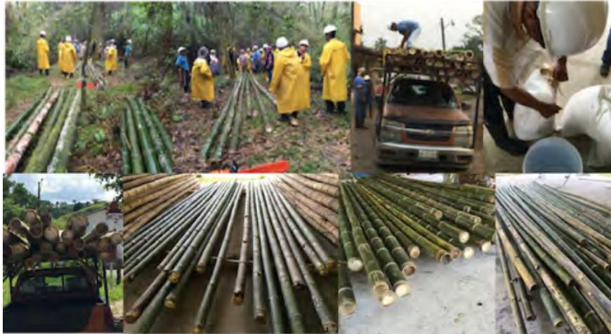
Imagen 80. Selección, corte, transportación al cobertizo de la unión de productores de bambú, limpieza y preservación. Fuente: autor.
