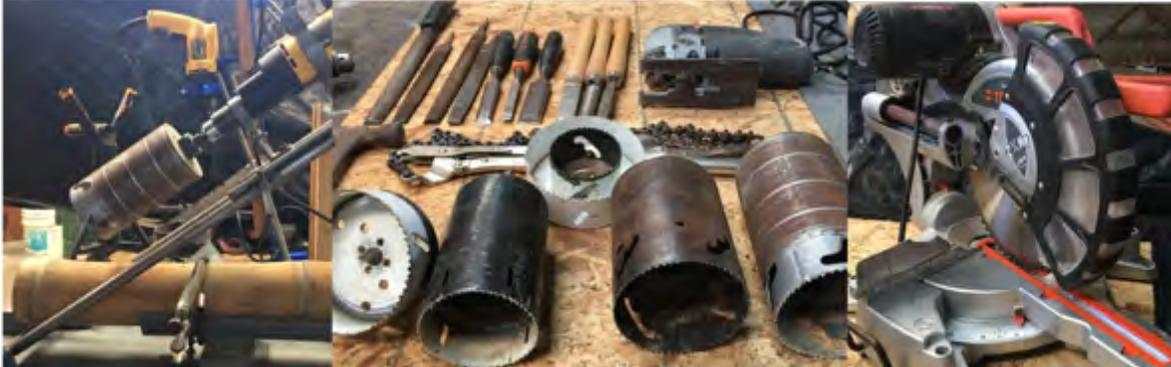
Imagen 132. Herramienta y equipo para cortes a boca de pescado. Fuente: autor.
