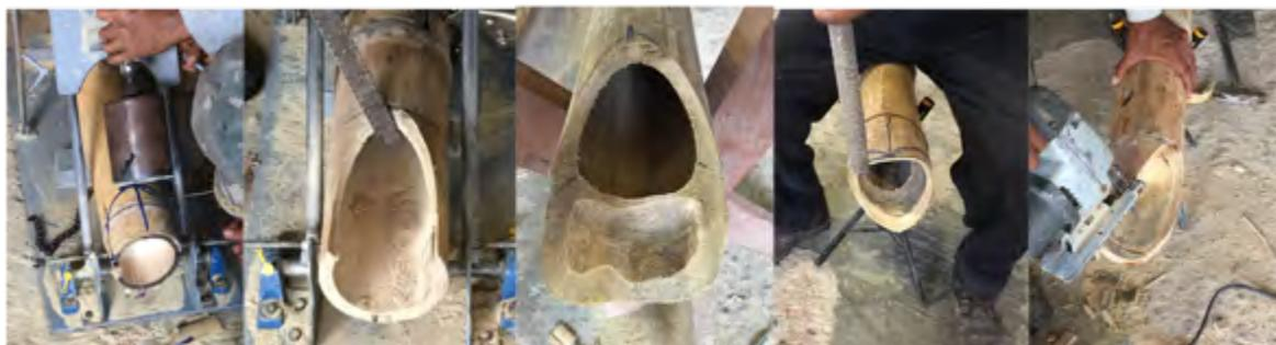
Imagen 105. Tipos de corte, boca de pescado utilizados en la armadura. Fuente autor.
