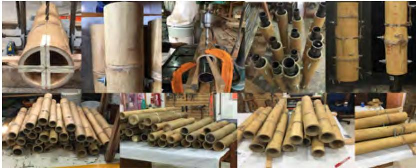
Imagen 83. Proceso de preparación de muestras ensayos “P”, perforación, colocación de varilla roscada de 3/8 plg y 1/2 plg A-307, con tuercas hexagonales y arandelas planas, perforación espécimen con tubo de acero de 1 1/2 plg, cédula 40, colocación de tubos de acero a muestras, colocación de varillas roscadas en la muestra, en la parte inferior y superior, muestras con y sin mortero varios diámetros. Fuente: autor.
