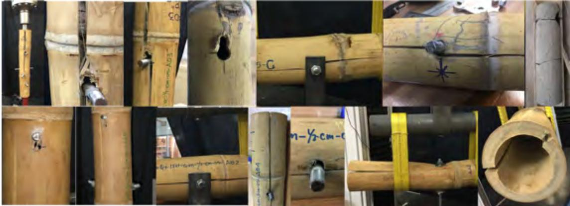
Imagen 87. Ensayos tipo “P” “Q” Y “T” sin y con mortero perno de ½ plg, *G. aculeata* y *G. angustifolia*, de la región de Hueytamalco, Puebla, fallas presentadas. Fuente: autor.
