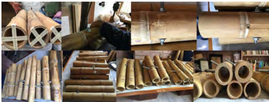
Imagen 84. Proceso de construcción de muestras ensayos tipo “Q” con mortero y sin mortero, para *aculeata* y *angustifolia*, trazo, perforación, colocación de varillas roscadas de 1/2 plg y 3/8 plg, varios diámetros. Fuente: autor.
