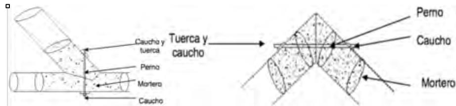
Imagen 11. Conexiones con mortero y perno roscado. Fuente: (Nolivos Valiente & Yacelga Díaz, 2010).
