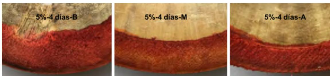
Imagen 45. Resultados, detalle de penetración-presencia de SB, concentración al 5 % en 4 días, partes baja, media y alta del tallo, preservadas por inmersión-difusión. *G. aculeata* de la región de Hueytamalco, Puebla. Fuente: autor.
