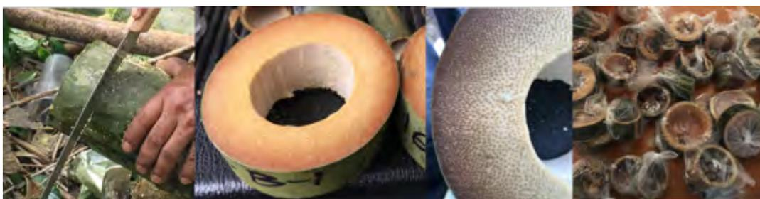
Imagen 36. Corte y preparación de muestras para medición de humedad inicial por fase lunar, *G. aculeata* de la región de Hueytamalco, Puebla. Fuente: autor.
