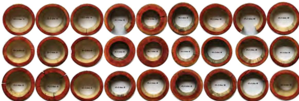
Imagen 40. Resultados de la evaluación penetración y presencia de SB, al 4 %, en 4,5 y 6 días en las partes baja, media y alta del tallo, preservadas con SB por inmersión-difusión. *G. aculeata* de la región de Hueytamalco, Puebla. Fuente: autor.
