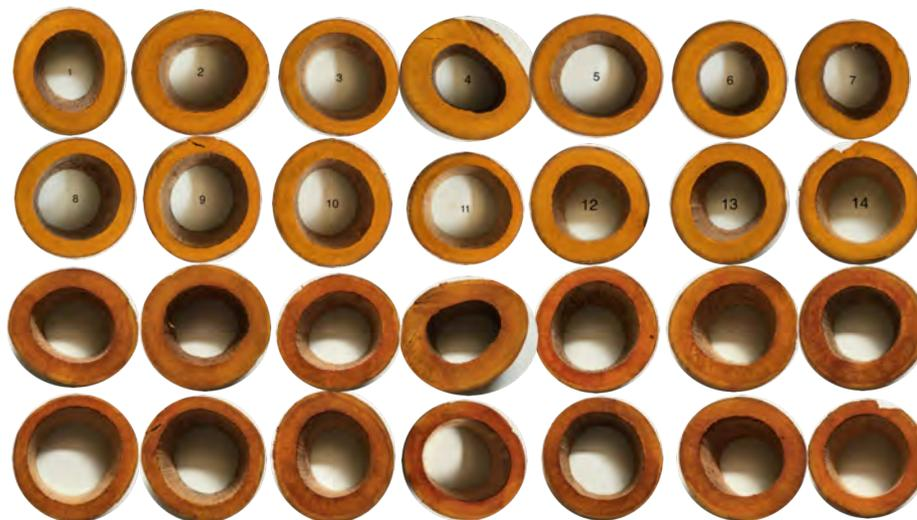
Imagen 135. Resultados de la evaluación niveles de penetración-presencia de SB, al 6 % de concentración durante 7 días, por inmersión-difusión en muestras de tallos del prototipo de vivienda rural, con *G. aculeata*, de la región de Hueytamalco, Puebla, con la metodología de (Erdoiza & Echenique 1980). Fuente: autor.
