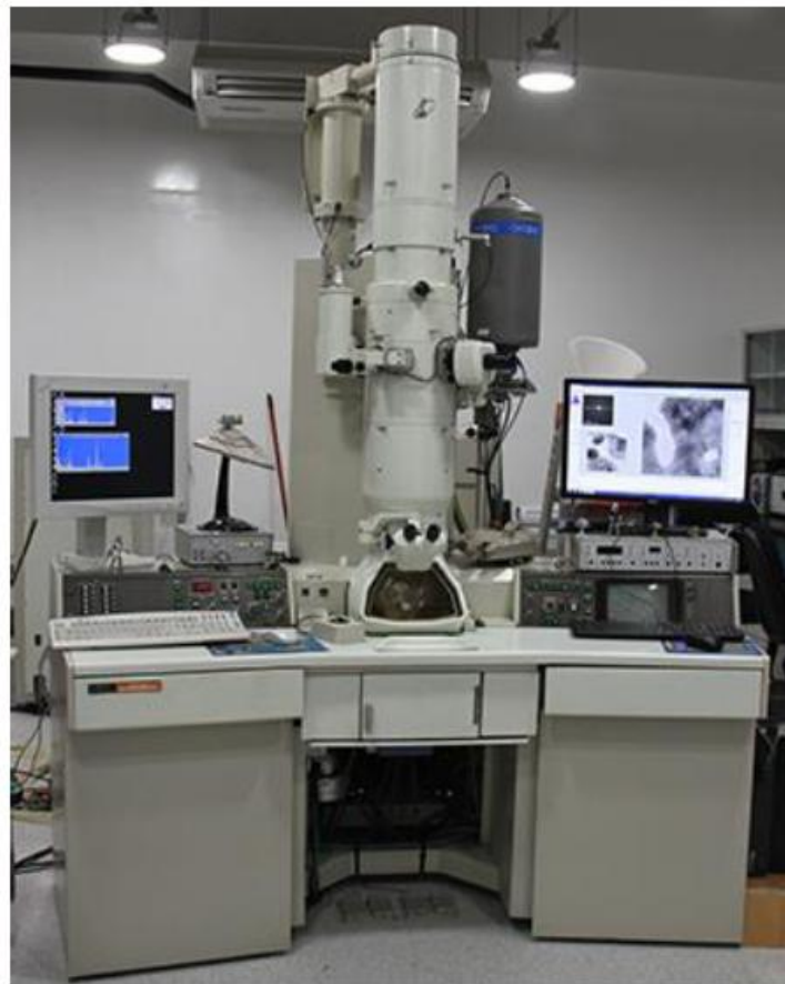
Figura 3.20 Microscopio electrónico de transmisión multifuncional JEOL JEM-2010, resolución: 0.14 nm, amplificación: 3000-1500k.
