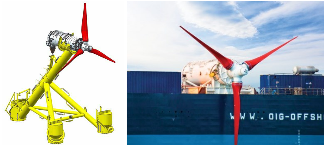
Figura 2.11: Turbina de corriente mareomotriz, Andritz Hydro Hammerfest. (Generador de inducción de 500 - 2,000 kW, profundidad de 35 - 100 m y peso de 150 t.)
