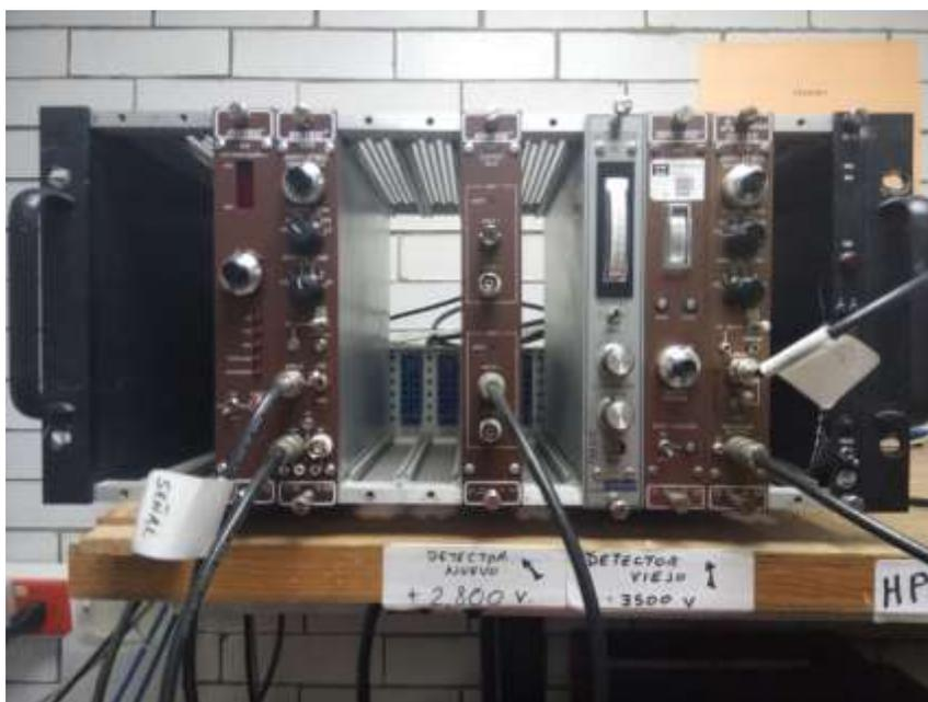
De izquierda a derecha podemos observar: fuente de alto voltaje, amplificador, MCA
