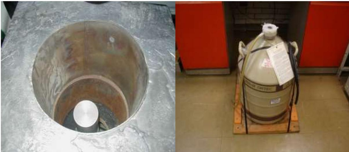
Figura 31. Detector dentro de blindaje y criostato (PAD-IFUNAM)
