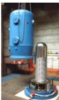
**Figura 2.1** Estructura externa del acelerador y el tanque que lo cubre.
