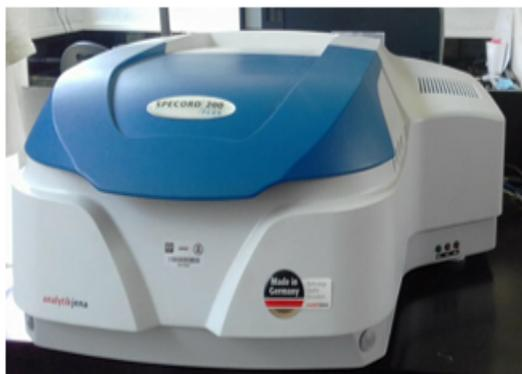
**Figura 2.13** Espectrofotómetro UV-Vis de doble haz modelo SPECORD 200 PLUS.
