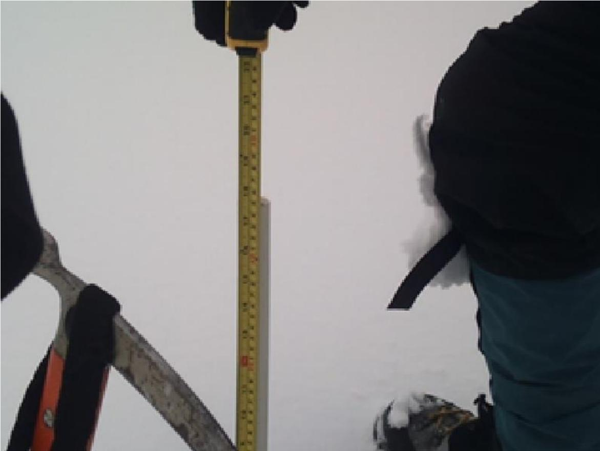
*Figura 3.2. Siguiendo la recomendación de Francou y Pouyaud (2004), se midió espesor de la nieve mediante un flexómetro y el piolet o un bastón. Se midió el espesor de la nieve en tres o cuatro puntos ubicados dentro de un círculo de un metro en torno a la baliza para tomar un valor representativo, así mismo, también se midió la “emergencia” que es la longitud de la baliza que emerge de la superficie de nieve.*
