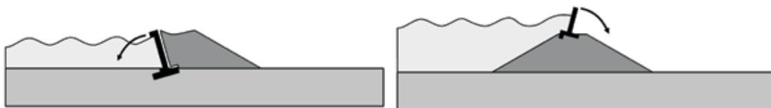
Figura 2.27 Inclinación de las paredes en un bordo compuesto debido a asentamientos diferenciales (Sharp et al. , 2013)
