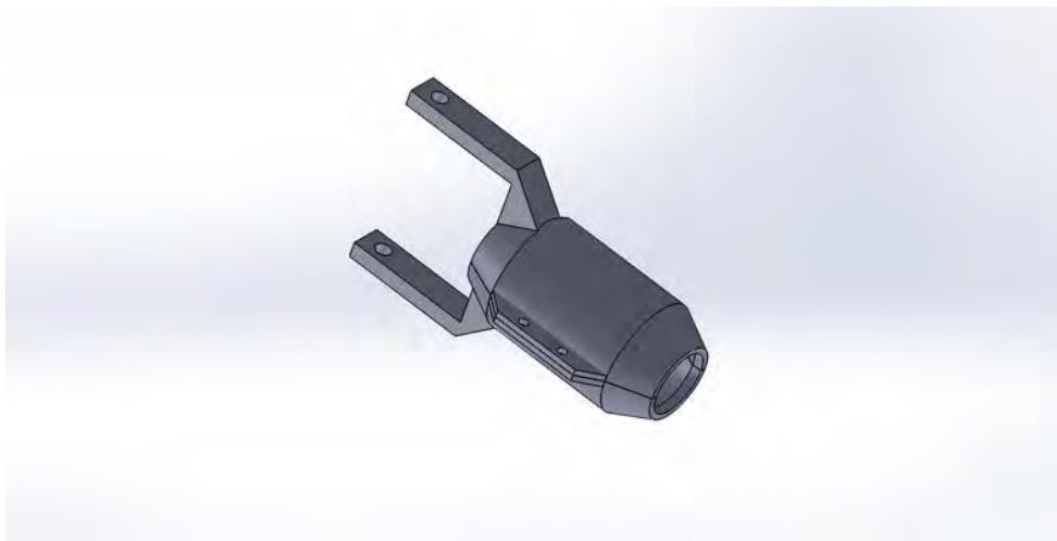
Figura 9. dispositivo cabezal hecho de material PLA (acido poli-láctico).
