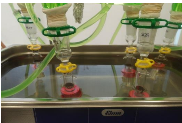
Figura 9. Extracción de los HAP aplicando la CEMAUF
