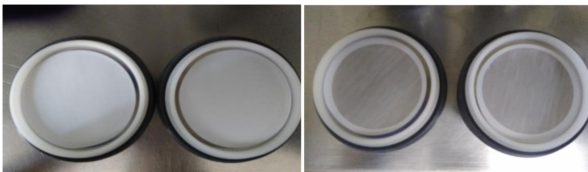
Figura 8. Filtros antes (izquierda) y después (derecha) de la colecta de PM_{2.5}
