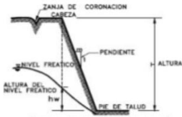
**Figura 1.1 Partes de un talud**
