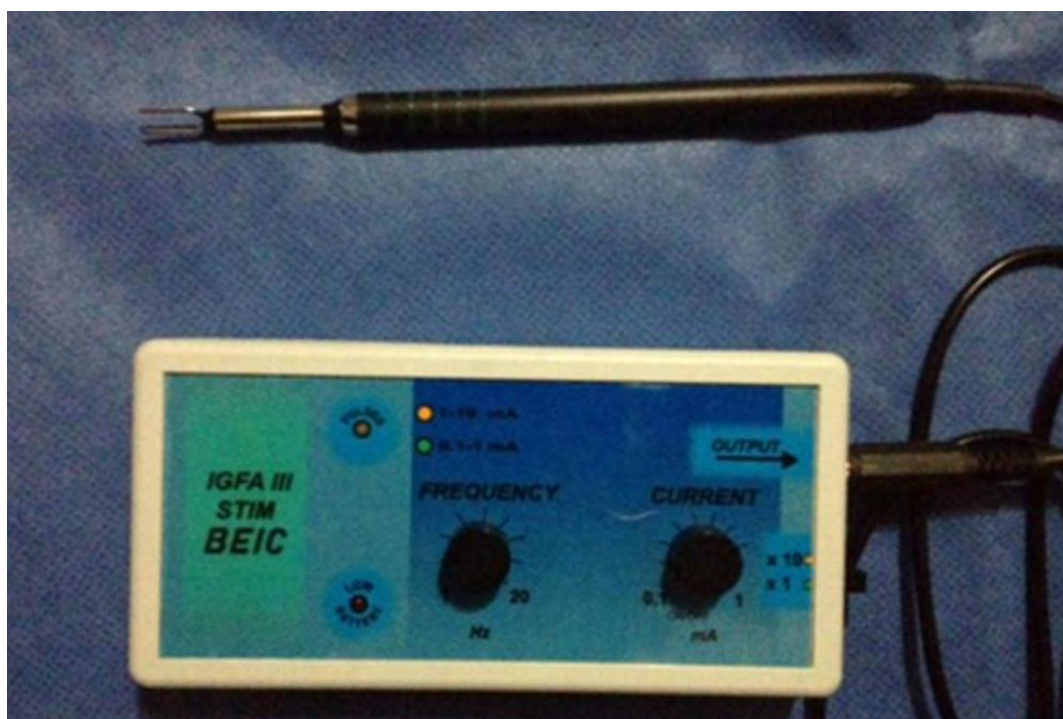
Foto 20. Equipo de estimulación nerviosa transquirúrgica. Marca BEIC-STIM, modelo IGFA III. Buenos Aires, Argentina.
