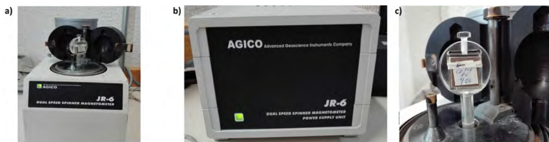
Figura 7.3: a)Dispositivo de giro y medición del magnetómetro. b) Fuente de poder del equipo. c) Porta-muestras.
