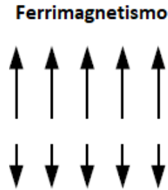
Figura 4.1: Acoplamiento antiparalelo, capas con momentos magnéticos de distinta magnitud, en sentidos opuestos. Modificado de: (Butler, 2004).
